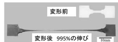
図1 アルミナを微量添加したジルコニアの超塑性変形前後の写真
