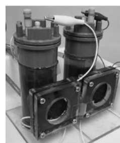
図2 実験装置 (MFC) と有機酸分解速度変化
