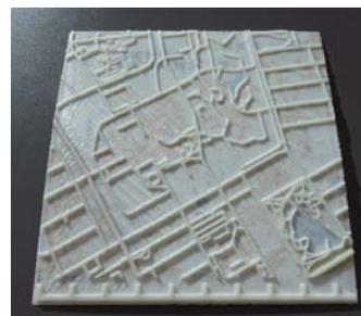
図2: 3Dプリンタで出力した触地図
