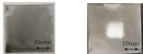
図4 液滴(左)、氷粒子(右)による洗浄後の試験片
