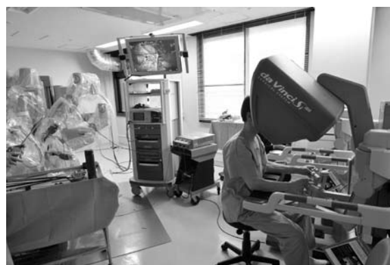
図1 術者はコンソール(右)に座り操作を行うことで、ロボットアーム(左)が連動して実際の手術を行なう。
