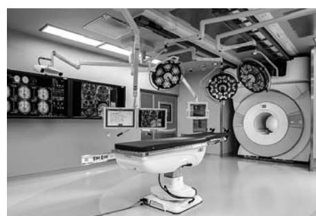
図2 天井懸架移動式高磁場術中MRI手術システム
