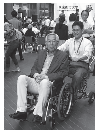
図3 汎用車椅子と連結したmPmの介護使用例
