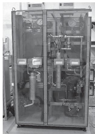
図1 高圧水素発生装置
