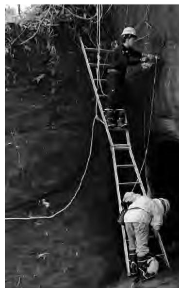
図 電動ドリルを用いた地層サンプル採取の様子
