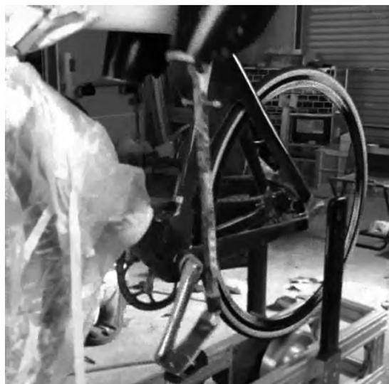
図1 フルスケールの可動式マネキンの下部骨組みペダリングテスト
