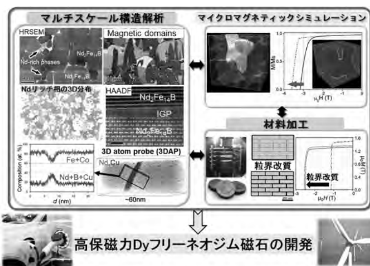
図1 究極性能を有する Dy フリー Nd-Fe-B 永久磁石開発に対する独自の複合的アプローチ：微細構造解析、マイクロマグネティックシミュレーション、材料プロセス。
