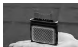
(b) 直接水冷型両面冷却 パワーモジュール
