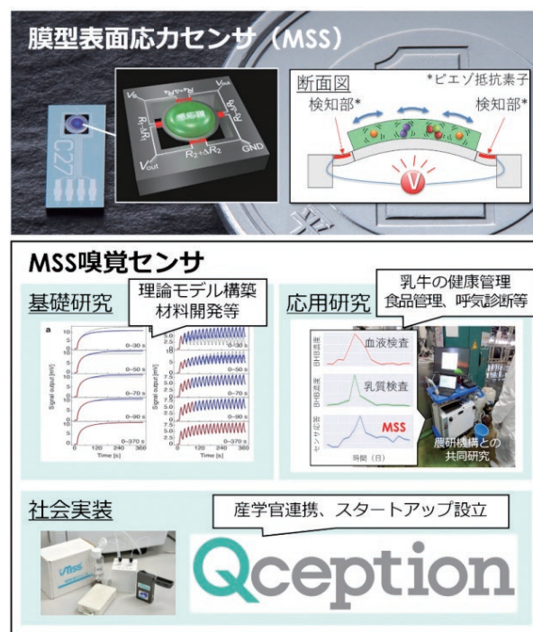
図 1. MSS の原理、および MSS 嗅覚センサのこれまでの研究開発概要。
