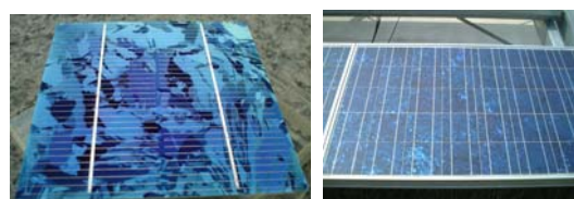
図 1. 結晶シリコン太陽電池セルとモジュール
