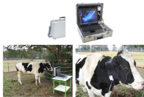
図1. 開発した携帯型のBAEP検査装置(上図)と牛の脳幹機能検査(下図)
