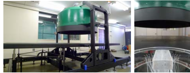
図2 竜巻発生装置の概観と風圧模型の設置状況
