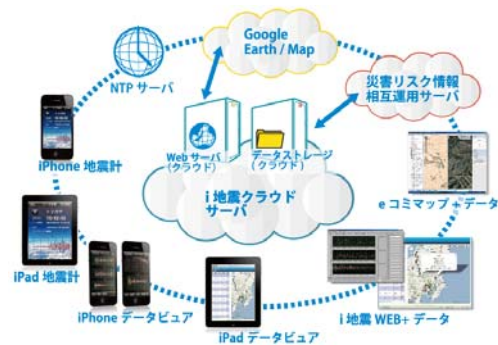
図1 「i地震クラウドシステム」の構成図
