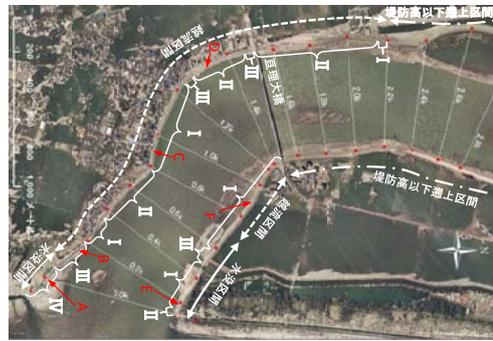
写真1 津波痕跡水位と堤防高との関係および被災状況
