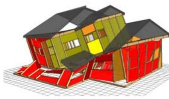
木造住宅の倒壊危険性評価
