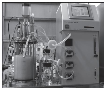
図2 5L容の卓上型培養リアクターでの培養の様子
