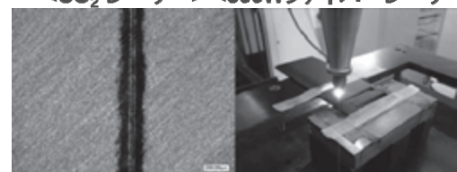
<2kWファイバーレーザー>レーザー加工の様子
