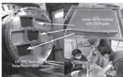
国際協力で行われるドイツ DESY 研究所における TPC 大型プロトタイプタイプのビーム試験
