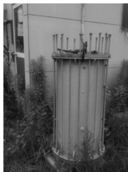
写真-1 原位置で用いたフィルターカラム
