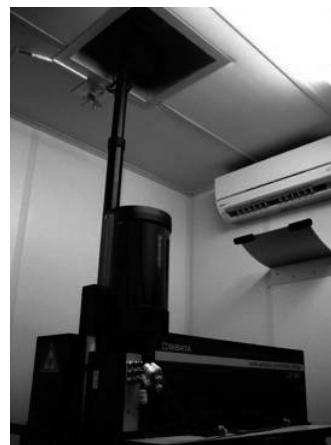
図1 国立環境研究所(茨城県つくば市)敷地内に設置されているライダー。これと同じものがアジア各地に設置されている
