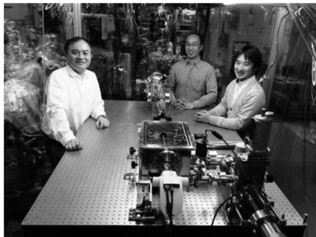
図 1: cSTXM の外観。集光素子や試料ステージが光学定盤中央の真空槽に収められている。
