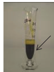
図2 スケールアップ実験における析出相 (試験管下部の褐色部が析出相) (3000mL → 6mL)
