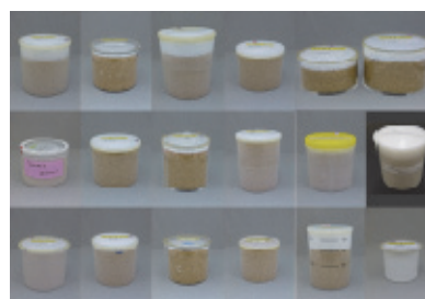
図2. 相互比較試験での参照試料(例) 17社、20種類の容器(376g~940g充填)を対象とした。
