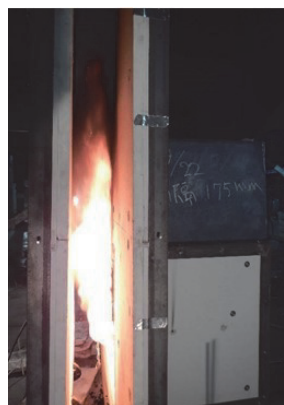
図2 ダブルスキン内の噴出 火炎性状の模型実験
