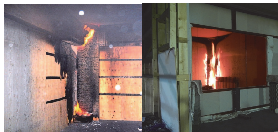
図4 天井不燃化による燃え止まりとフラッシュオーバー の遅延効果を確認する火災実験
