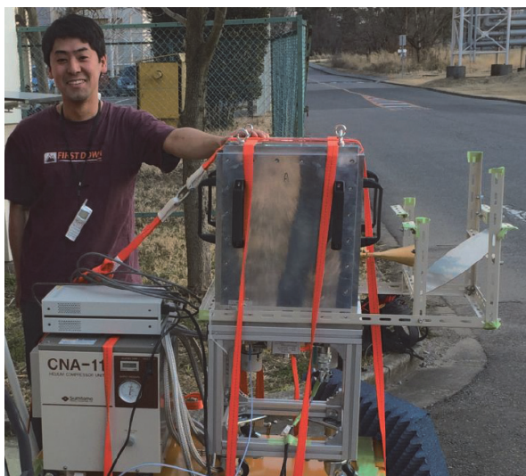
図1 電波天文・宇宙観測技術を応用した大気水蒸気量モニターKUMODeS (クモデス)
