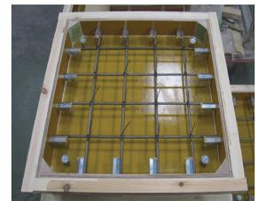
写真2 試験体基盤の型枠
