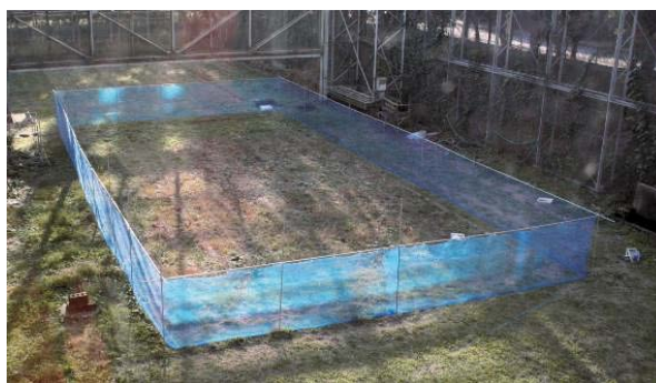
図 2. 上面に設置する糸の間隔を変える試験に用いた枠
