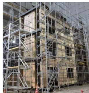
写真3 実大3層構面静的加力実験
