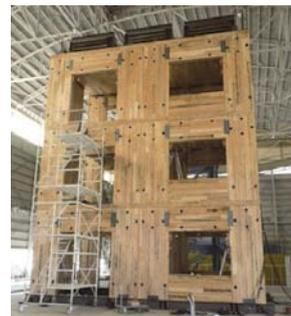
写真2 実大3層構面振動台実験
