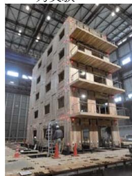
写真5 実大5層振動台実験
