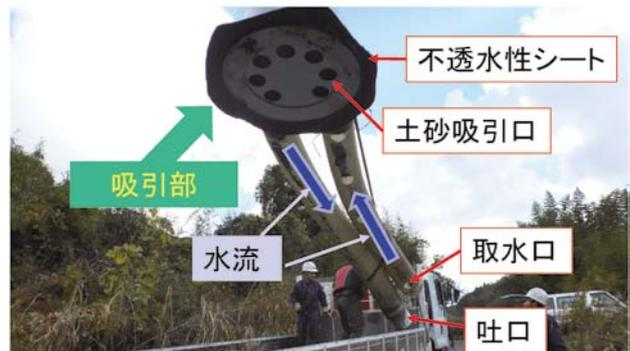
図-1 φ300mm 潜行吸引式排砂管
