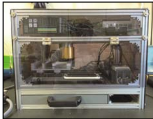
注射器溶融無害化装置
