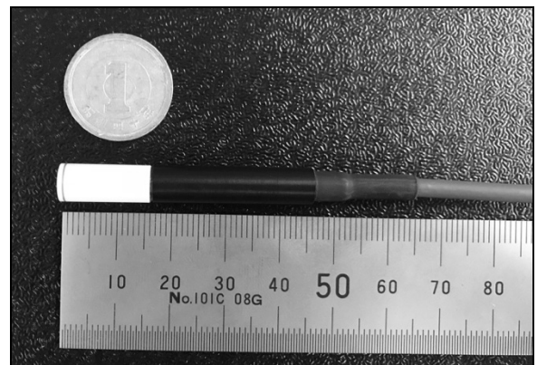
図2 人工ダイヤモンド検出器 先端の検出部分は円筒形であり、その中に極薄の円盤状ダイヤモンド素子が組み込まれている。
