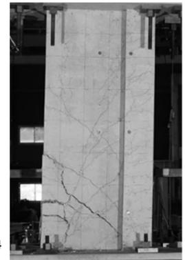
写真1  $R=3\%$ ピーク時の破壊状況
