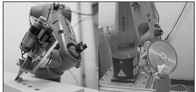
図1 ロボットによる加工 (左:角ノミ、右:丸ノコ)
