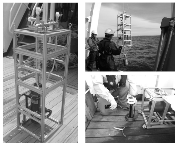
図1 投げ込み式海水ろ過装置
