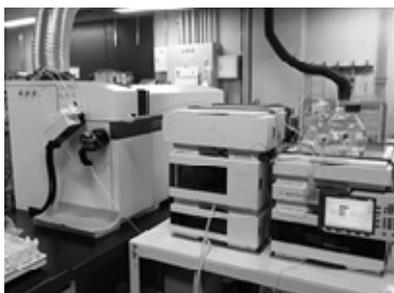
図：化学形態別分析に使用するHPLC-ICP-MS装置
