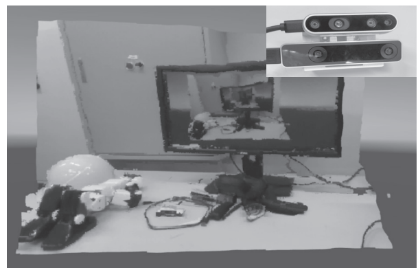
図2 RGB-Dカメラによる環境のVR表示の一例
