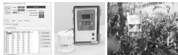
図4. 圃場利用型の忌避効果音防除装置の開発。栽培施設環境に配慮して、交尾阻害音を効果的に照射できる装置を開発しました。久保田ら, 応動昆, 63:97-107, 2019
