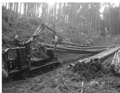
クラムバンクスキッドによる集材作業と供給シミュレーション
