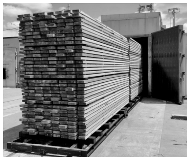
弱減圧乾燥機を用いたスギ間柱材の実証乾燥試験
