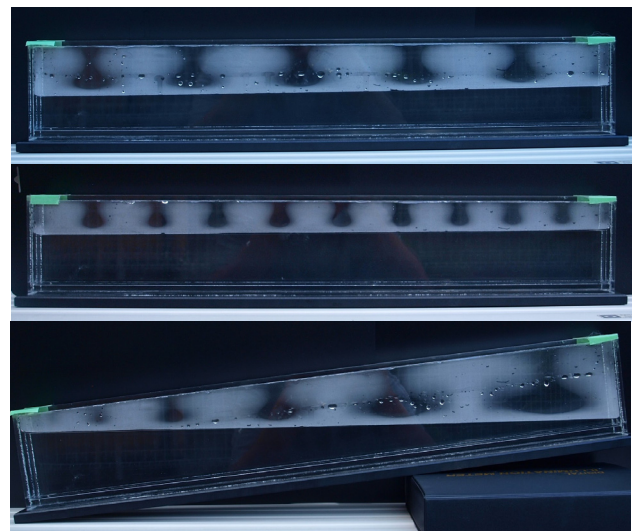
図2 上から、ぬるま湯が5分目、7分目のときに形成されたベナールセルと、タイリュウジャーを傾けて、空気層の厚さが徐々に変化する場合はベナールセル鉛直パターン。
