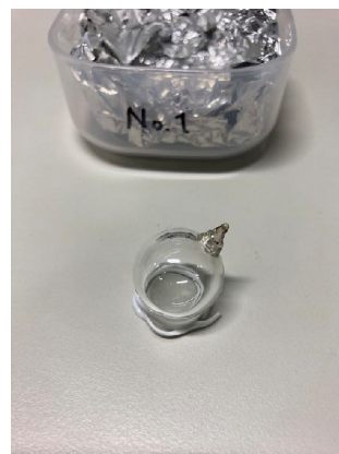
図 2: ^3\text{He} を封入したガラスセル
