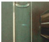
図2. 二光子吸収による空間選択励起。右から近赤外光を集光入射し、試料の中央部でのみ二光子吸収由来の発光が見られる。
