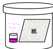
図1 気相コーティング法による紙の撥水化は密閉容器内に紙と試薬を入れて一定時間加熱するだけで完了。
