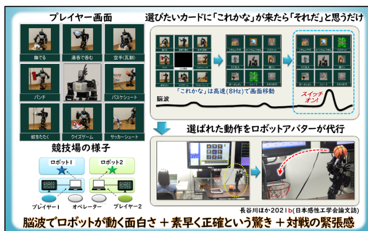
図1 脳波によるロボット制御システムの概要
