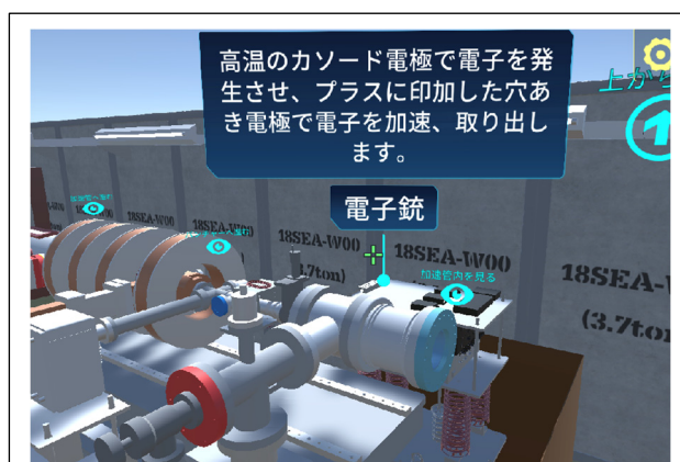
Fig. 1 教育加速器のVR画面。電子銃、バンチャー付近とその説明。
