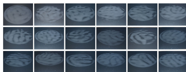
図2 厚さ 12 mmの空気層に形成されたベナール・セルの縞模様。同じものはない。円の直径は 18 cm。
