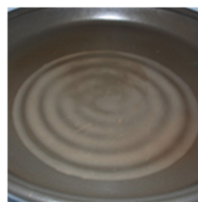
図3 同心円状の縞模様。一番大きな円の直径は 21 cm。空気層の厚さは 11 mm。
