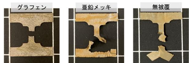
図3 48 h腐食後の各試料試験片
