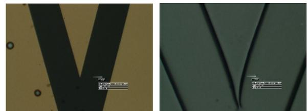
図2 Y分岐部分のマスクと作成したリソグラフィパターン
