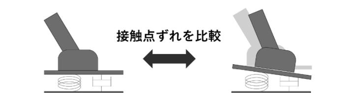
KineticsObserver で取り入れられている visco-elastic モデルの概略図
