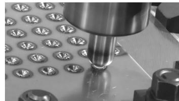
図2 開発工具による低炭素鋼板のFSSWの外観
